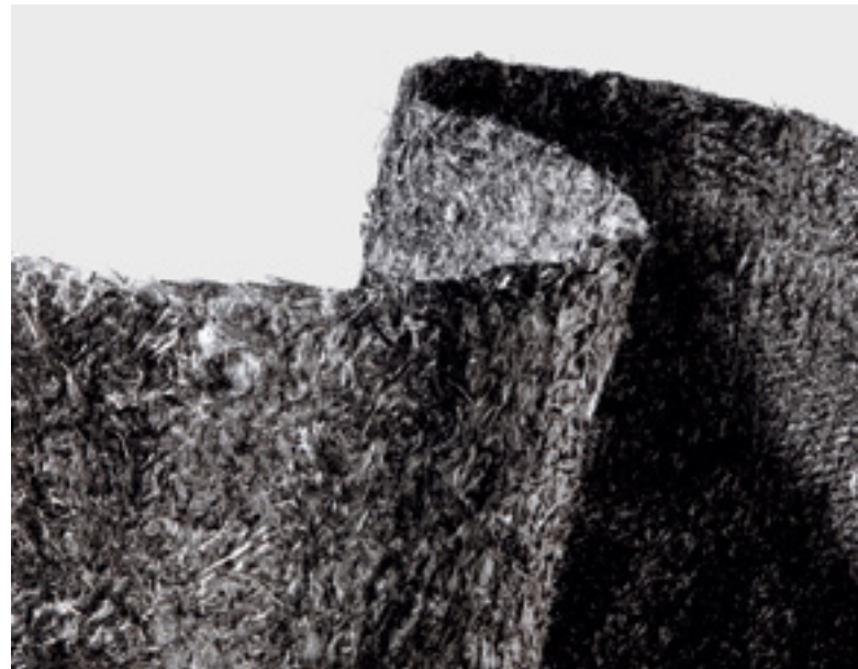
↑ SIGRATEX isotropes Vlies aus Carbonfasern
