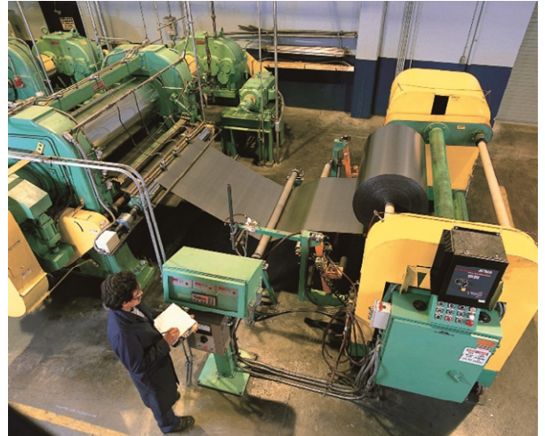
Die "Ultraline", die neue 60" breite Folienstraße, die 1988 in Valencia in Betrieb genommen wurde.
