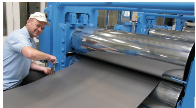
Erwin Bauer, Schichtführer der Walzenstraße, überprüft die Dicke der Graphitfolie
