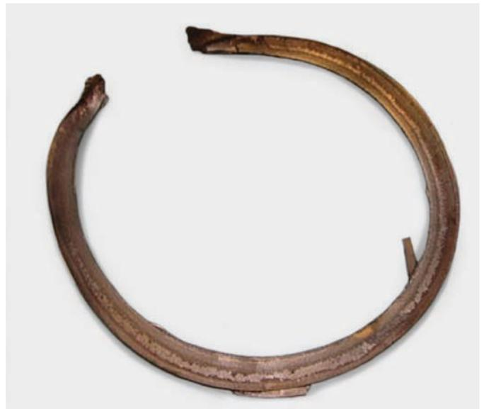
↑ Bilder einer Graphitflachdichtung, die nach starkem oxidativem Angriff ausgefallen ist.
